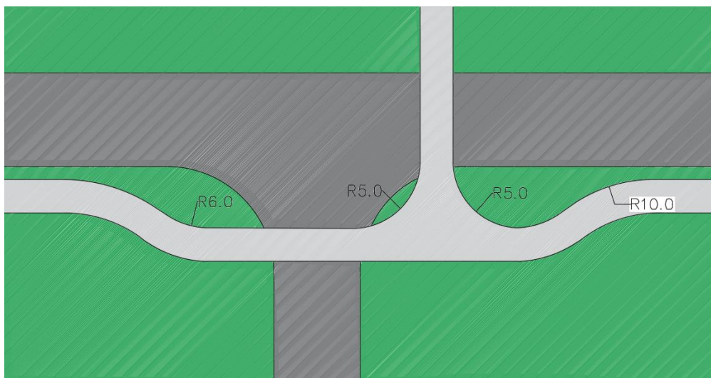
Figur 17. Exempel på utformning som ger en mjuk linjeföring för cykelbanan förbi en korsning.
